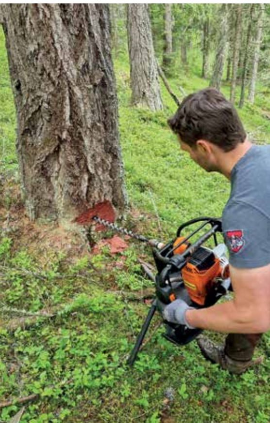
Gebohrt wird am Stammfuß, auf der Druckseite des Stammes, leicht schräg nach unten.
