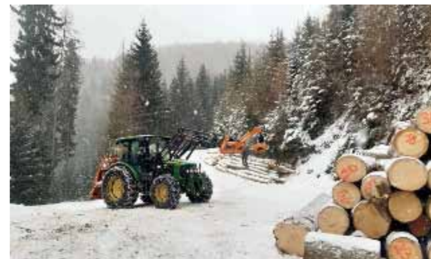
Die Kombination eines Traktor-Seilwindengespannes mit einer Rückzange erhöht die Flexibilität sowie die Einsatzmöglichkeit.
