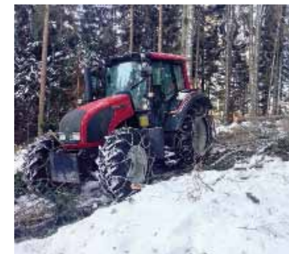
Die Frontgewichte am Traktor reduzieren das Aufbäumen.
