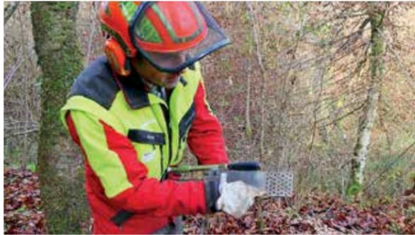
Der mechanische Fällkeil sorgt für eine erschütterungsfreie Fällung. Fotos: Zobl
